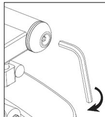
Проверьте и затяните все крепежные соединения тренажера, перед его использованием и в дальнейшем регулярно следите за их состоянием. Рекомендуется проверять затяжку основных крепежных элементов министеппера через каждые 7 дней тренировок и подтягивать их при необходимости.
