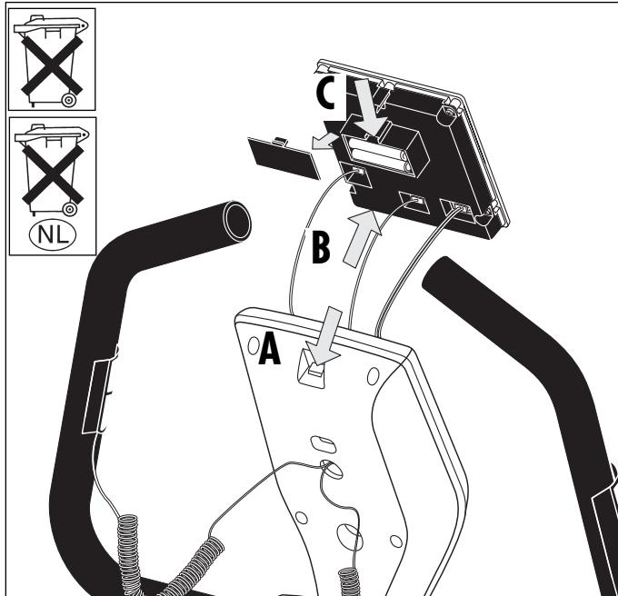
Eine schwache oder erloschene Computeranzeige macht einen Batteriewechsel erforderlich. Der Computer ist mit zwei Batterien ausgestattet. Nehmen Sie den Batteriewechsel wie folgt vor:
