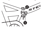
Рис. 29: Замок рамы дешевого складного велосипеда: 1. Рычаг эксцентрика; 2. Корпус замка.
