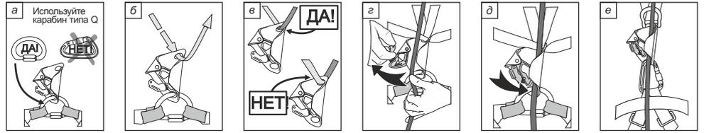
**Рис. 5. Установка жумара на канат**
