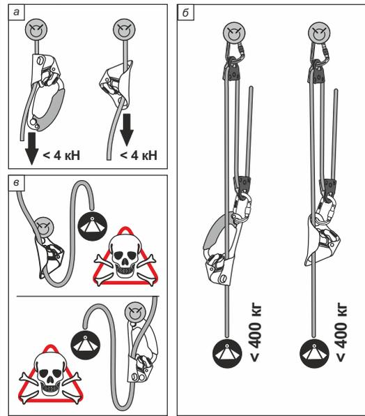
**Рис. 9. Подъем с использованием зажима со стремнем**
