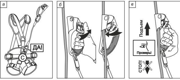
**Рис. 6. Положение жумара на вертикальных перилах**
