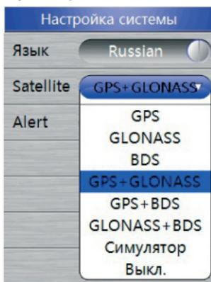
Нажмите ВВОД, чтобы изменить спутники GPS, BEIDOU или ГЛОНАСС. Пользователь также может отключить спутники на этой странице.
