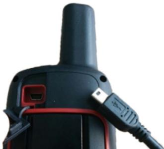
1. Поднимите резиновую заглушку порта mini-USB на задней панели навигатора, вставьте кабель.
