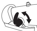
Рис. 31: Замок рамы складного велосипеда в открытом положении, предохранитель разблокирован
