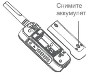
Снимите крышку аккумуляторного отсека.
