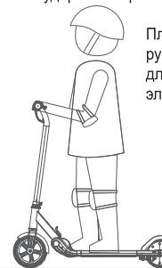
Плавно нажмите на ручку акселератора для активации электромотора.
