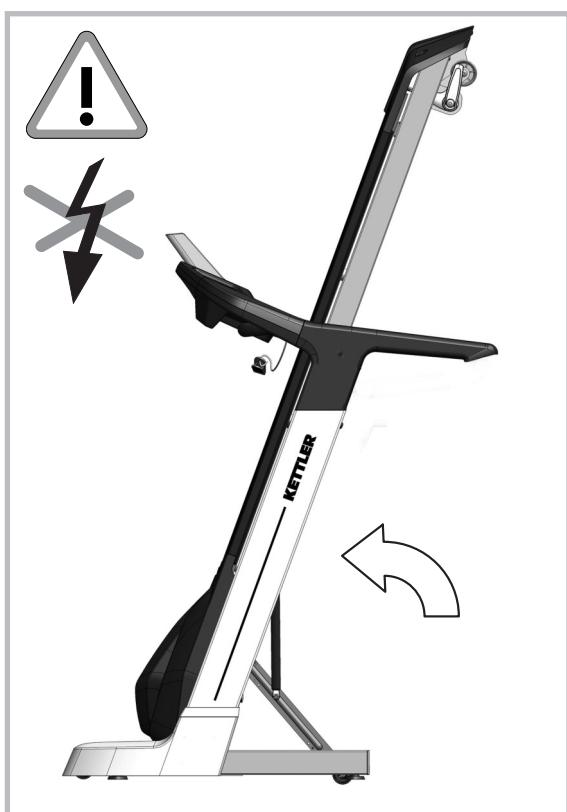
**D** **Achtung!** Stellen Sie das Laufband nur aufrecht, wenn die Steigung der Lauffläche in der niedrigsten Position ist! Ansonsten besteht Beschädigungsgefahr!
