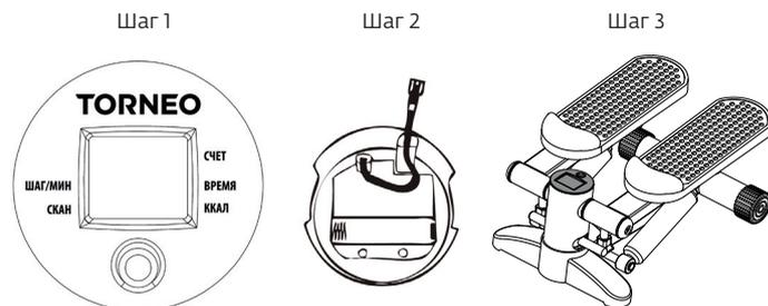
В случае отсутствия сигнала на тренировочном компьютере во время тренировки (например, не считает количество шагов), отрегулируйте положение сенсора (26) следующим образом:
