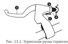
Рис.13.1: Тормозная ручка тормозов V-типа и ее регулировки
