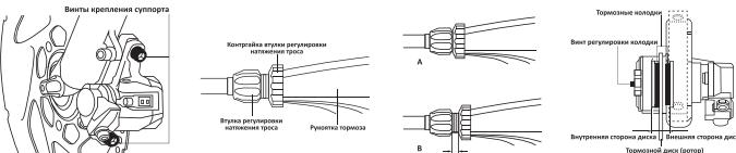
и внутренней стороной ротора дискового тормоза. Зазор между колодками и обеими сторонами ротора должен быть одинаковым 0,2-0,5мм. По мере износа колодок ход рукоятки тормоза будет увеличиваться, а эффективность торможения снижаться. Для компенсации увеличения зазора, вызванного износом колодок, так же, используйте втулку регулировки натяжения троса. Для этого выкрутите втулку на 1,5-2 оборота (Рисунок В) и проверьте эффективность работы тормоза. Зафиксируйте втулку контргайкой.
