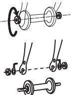
Рис. 10: Крепление колеса с помощью гаек
