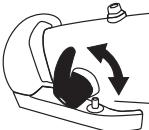
Рис. 31: Замок рамы складного велосипеда в закрытом положении, предохранитель разблокирован
