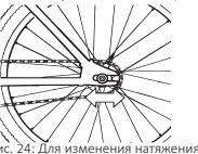
Рис. 24: Для изменения натяжения цепи следует двигать ось заднего колеса в дропахтах рамы.
