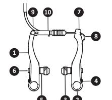
Рис. 13.2: Тормоза V-типа и их регулировки
