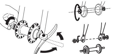
Рис. 9: Эксцентриковый зажим колеса
